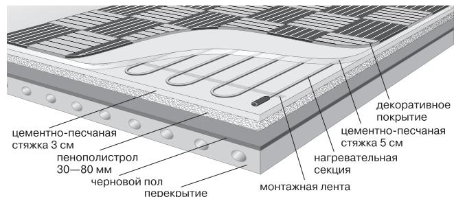
При установке комплекта теплого пола под плитку применение теплоизоляции не допускается, поскольку это может привести к растрескиванию слоя клеевого раствора толщиной 5–8 мм, покрывающего нагревательный кабель.
