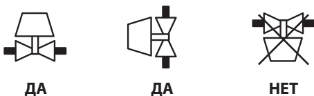
Рис. 3. Рекомендации по ориентации крана в пространстве.
